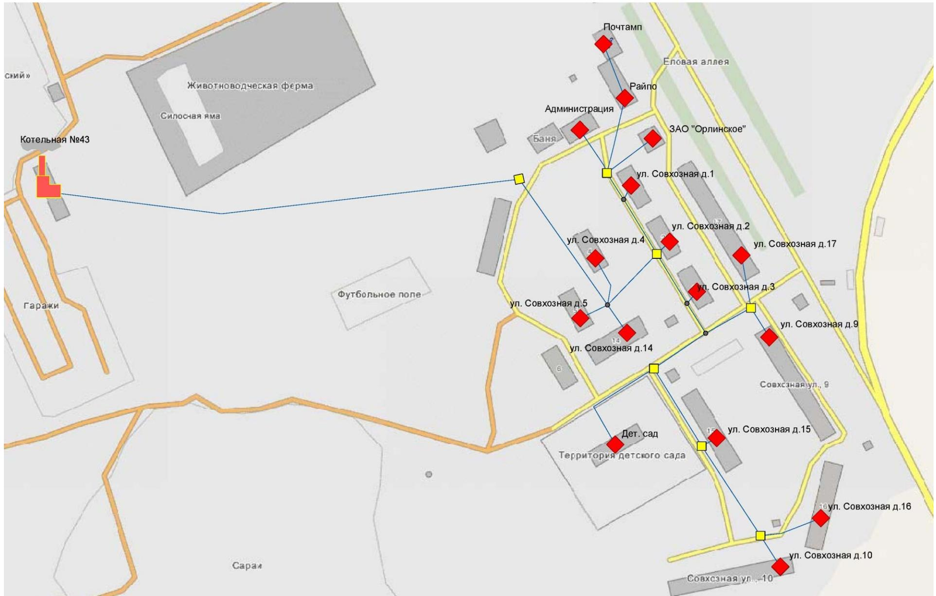
**Рисунок 1.6. Схема тепловых сетей котельной №43 д. Лампово**
