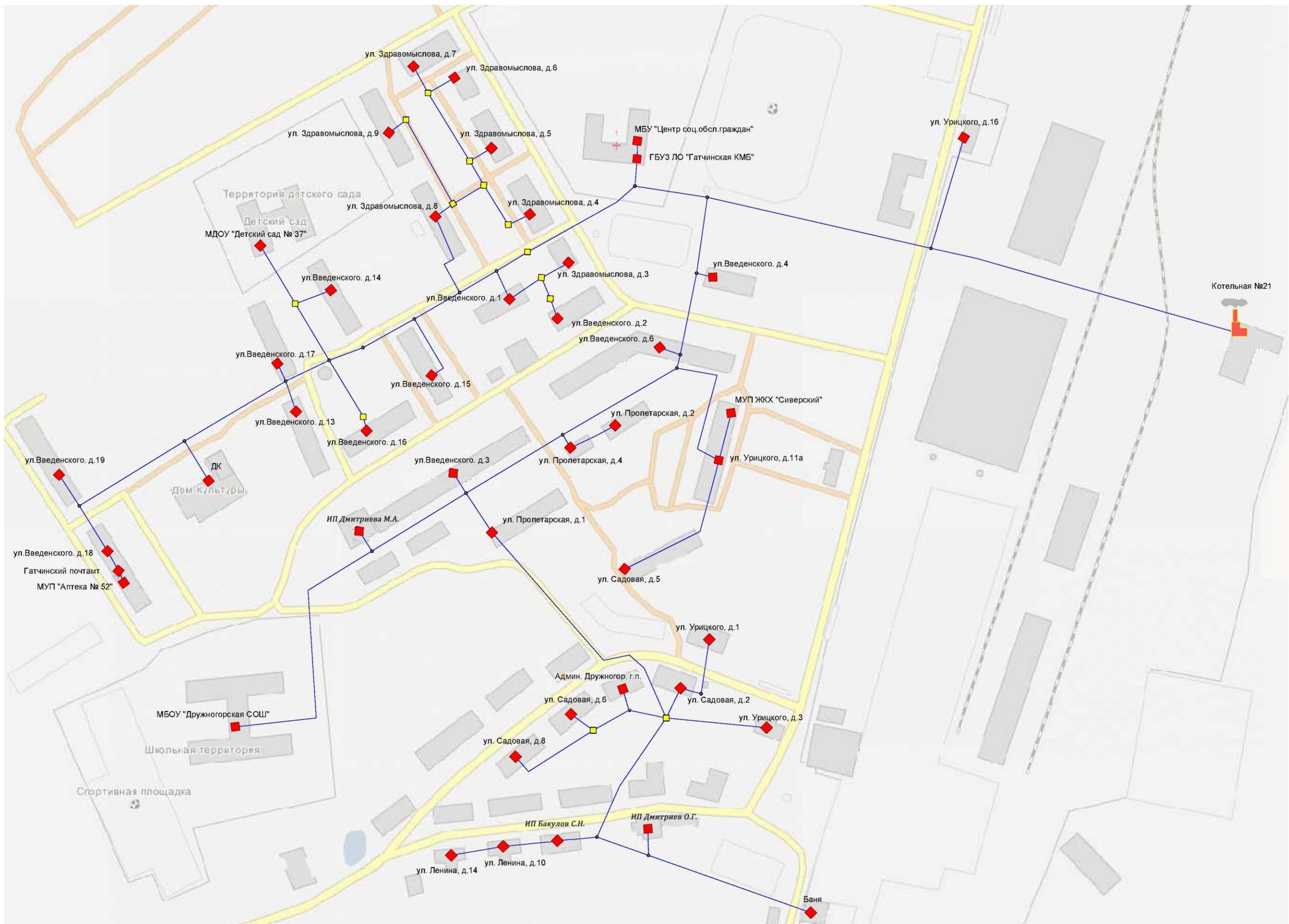
**Рисунок 1.4. Схема тепловых сетей котельной №21 пос. Дружная Горка (контур отопления)**
